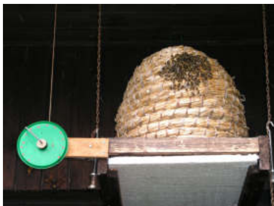
Das liebe Geld reicht nicht für eine elektronische Stockwaage? Eine mechanische zu bauen, ist für die Schüler eine echte Herausforderung.
